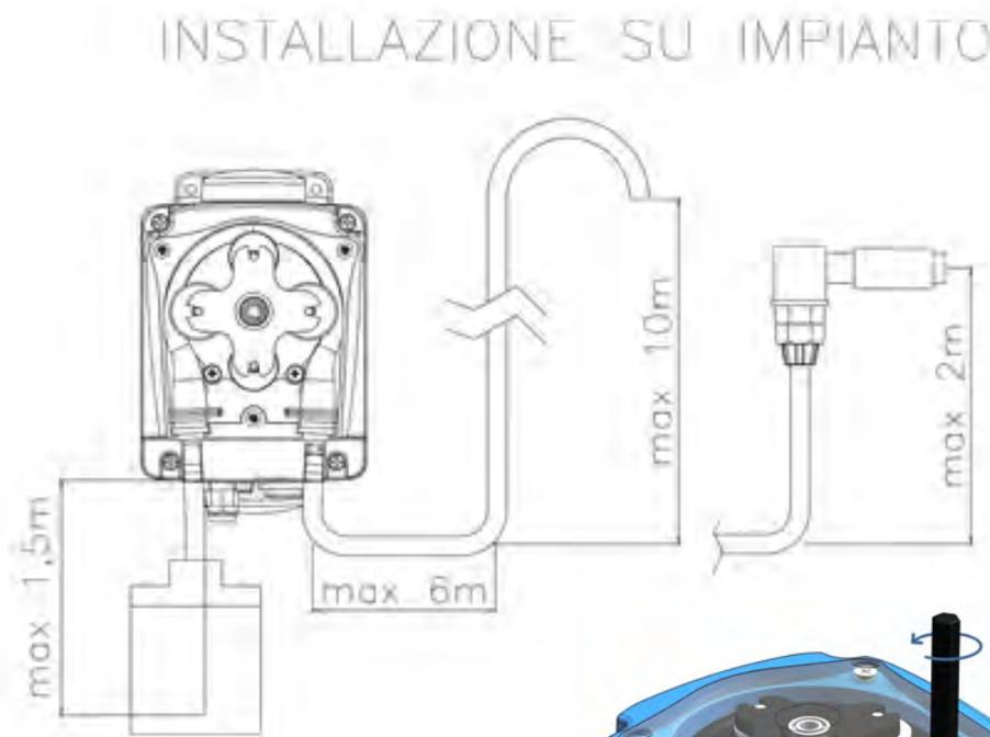
La pompa peristaltica serie BH3-V permette di variare il numero di giri del motore agendo su di un potenziometro regolabile mediante l'apposito giravite fornito in dotazione.
